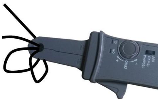
图 4 提高电流灵敏度方式
