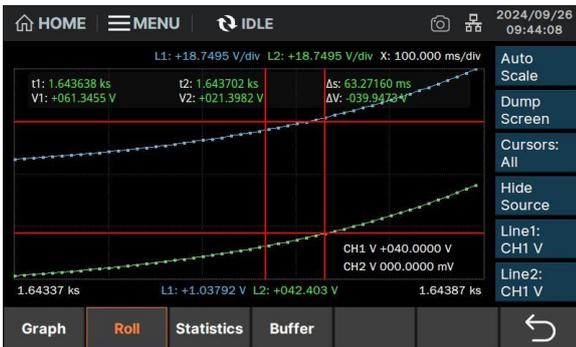
**Roll**: 视图: 显示并设置通道状态和输出值、Y 轴数据类型、光标数据，以及进行屏幕转储保存，更改图形定标以自动适合图形中的迹线。
