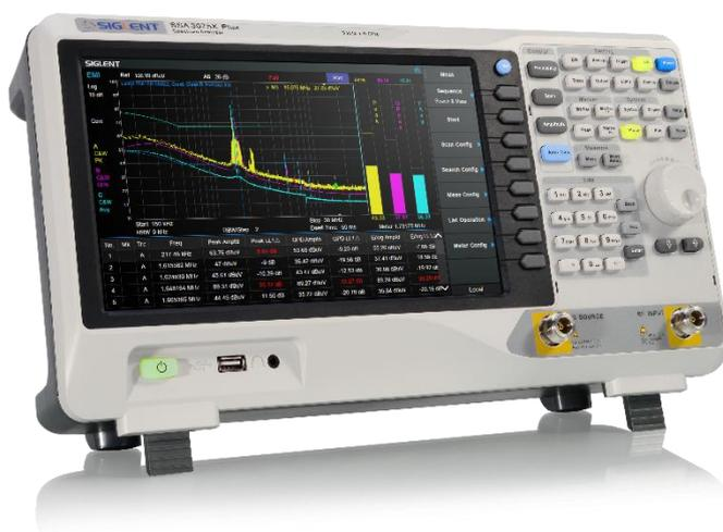
Figure 27 使用频谱仪进行 EMI 测试
