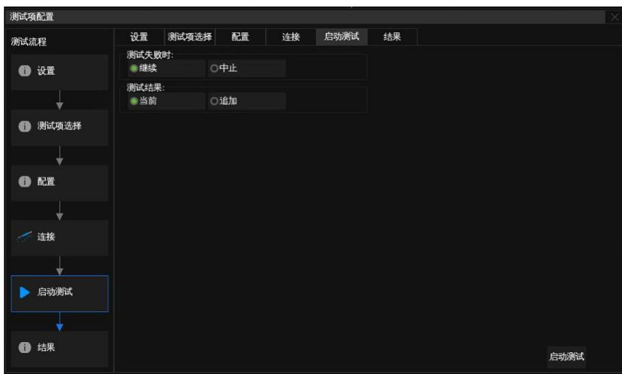
在接下来的测试过程中，按照弹窗提示完成测试即可，测试项全部完成后会弹出测试结果。若一轮测试中选择了多个测试项目，进行到下一个项目时会有弹窗提示该项目的接线方式，支持中途返回“配置”栏目修改该测试项的信源，修改后点击弹窗中的“启动测试”即可继续测试。
