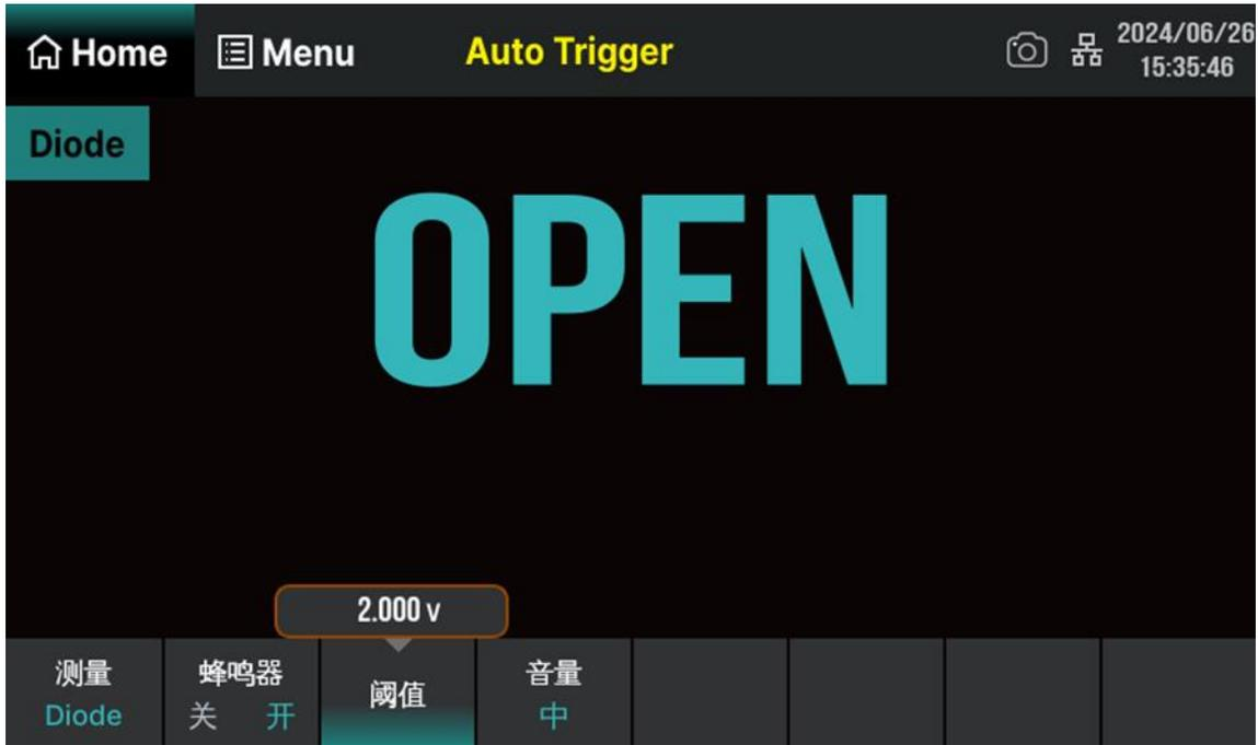
图 7-5 设置导通电压
