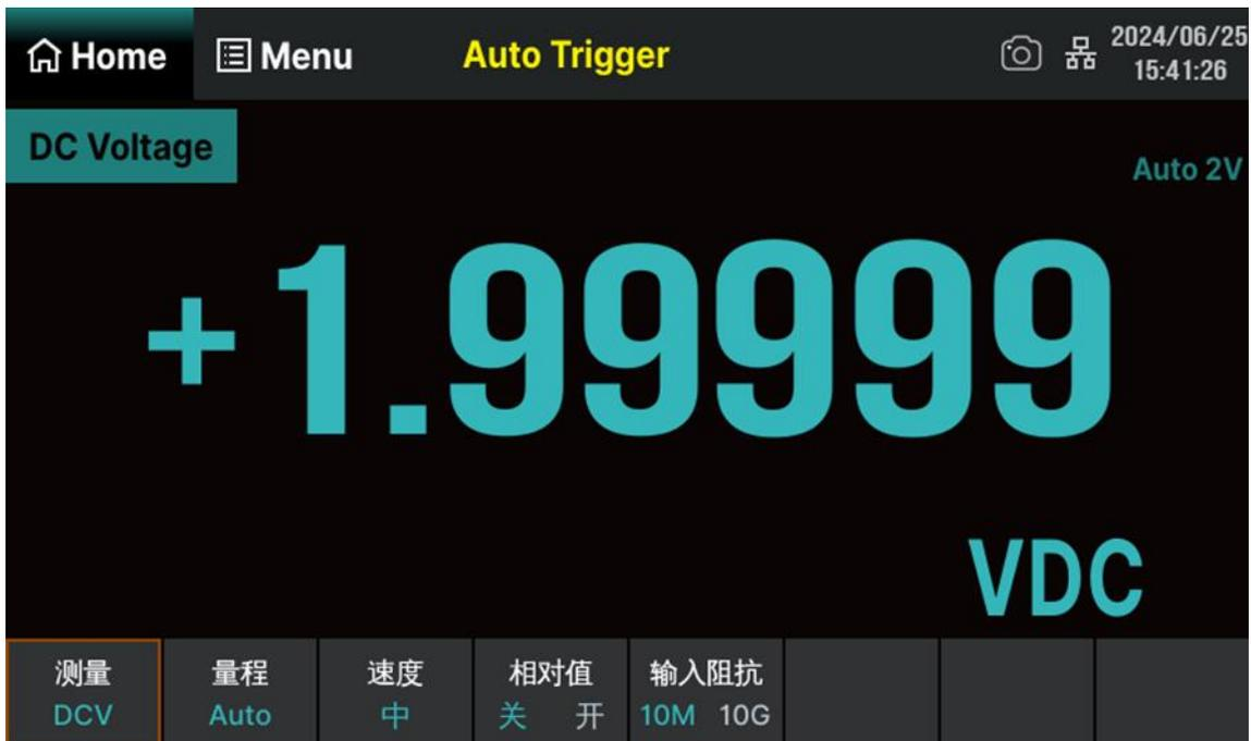
图 7-7 直流电压测量界面
