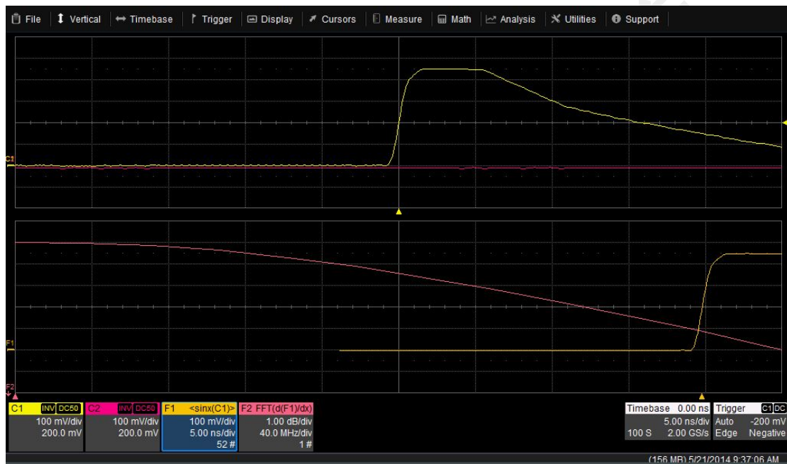
图 8 鼎阳 SDS3050 的快沿 FFT 运算
