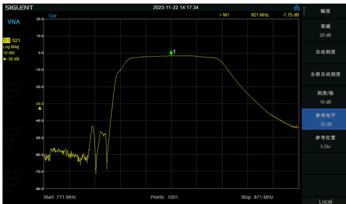
图 5: SVA1000X 关于滤波器模块的测试结果
