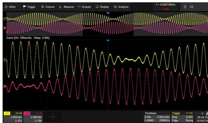
图 7 输入正确范围内的电压（10Vpp），我们可以看到此时波形的边缘是光滑的
