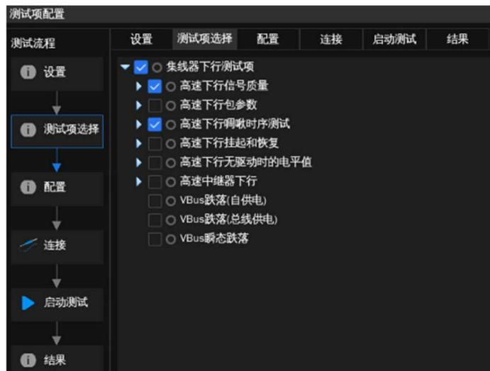
**主机：**高速下行信号质量、高速下行包参数、高速下行啁啾时序测试、高速下行挂起和恢复、高速下行无驱动时的电平值、全速下行信号质量、低速下行信号质量、VBus 跌落、VBus 瞬态跌落
