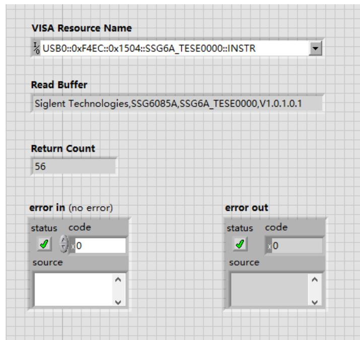
在这个例子中, VI 打开一个 VISA 会话到 USBTMC 设备, 写入一个命令到设备, 然后读回并响应。此例中, 发送的特定的命令是设备 ID 查询。请与您的设备制造商核对设备命令集。在所有通讯完成后, VI 关闭 VISA 会话。
