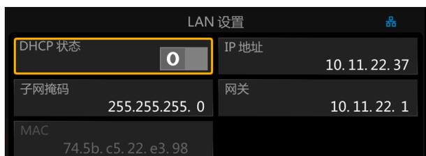
成功连接到 LAN 后，可以通过 WebServer 或通过 NI-VISA、Telnet 或 Socket 发送 SCPI 命令来远程控制仪器。
