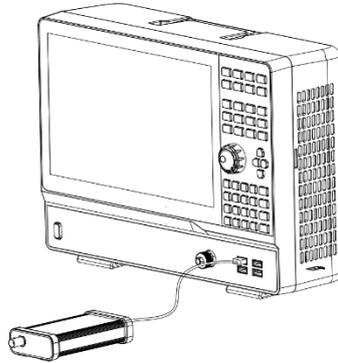
使用附带的 USB 连接线将 NSD28 噪声源驱动器接入频谱分析仪的 USB 接口，若连接识别成功，频谱分析仪会显示提示 “INFO\_NSD\_PLUG\_IN”，再将 NSD28 噪声源驱动器的+28V 脉冲电源输出接口使用附带的 BNC 连接线与适配噪声源的输入偏置接口连接。
