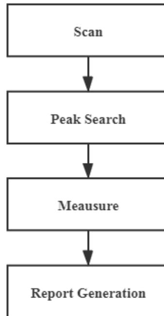
图 8-3 CISPR EMI 测试流程
