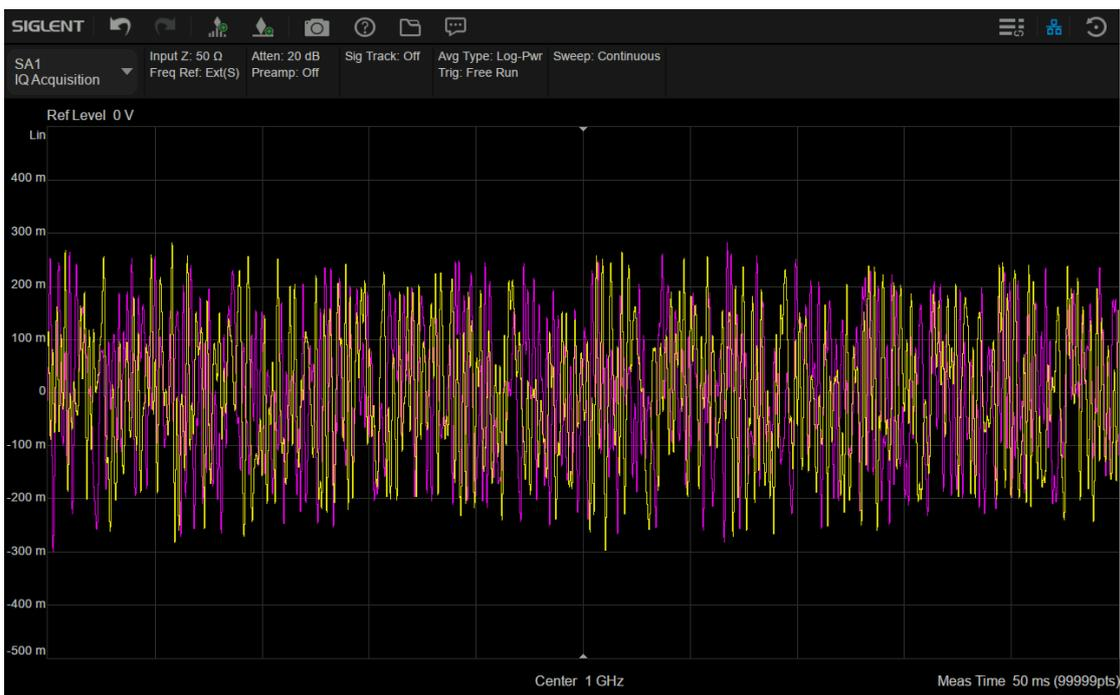
3) 单击 **幅度**，调整参考电平、刻度和测量时间，以便在屏幕上更好地显示 I/Q 波形。
