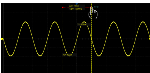
将手指放到光标位置后单点移动控制光标的位移
