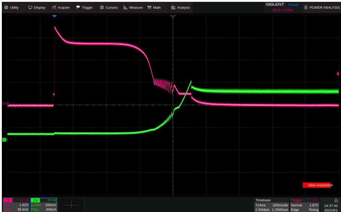
上电时 MOSFET 上的电压和电流波形
