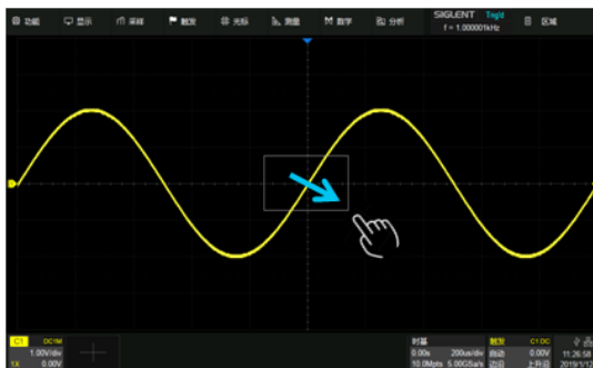
将手指放到光标位置后单点移动控制光标的位移
