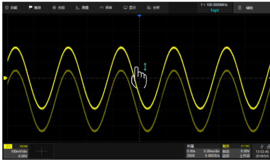
通过单点上下移动控制波形的垂直位移。当多个通道打开时，控制的是波形离触摸区域最近的通道
