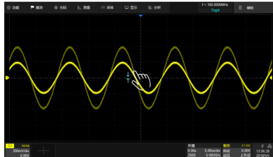
通过水平方向的两点缩放手势控制波形的水平档位
