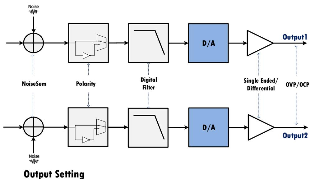
图 13.1 输出设置原理框图
