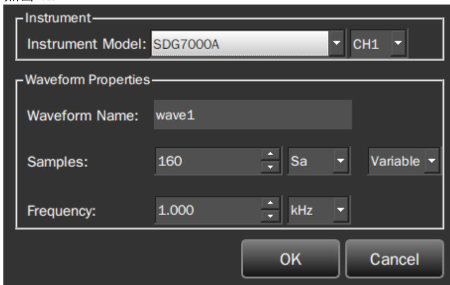
6. 通过 **Waveform** > **Sine** 创建一个正弦波，并在随后弹出的设置对话框中设置幅度：选择“Max/Min”，随后设置 HighLevel = 2.5 V，LowLevel = 0 V
