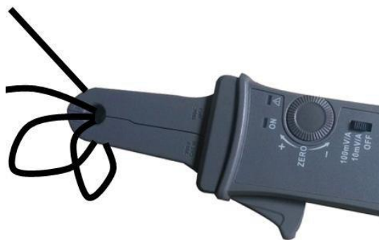
图4 提高电流灵敏度方式
