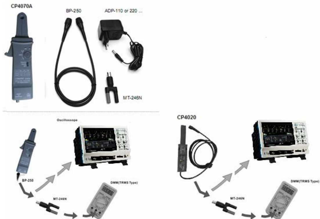
CP4000 连接示波器或万用表示意图
