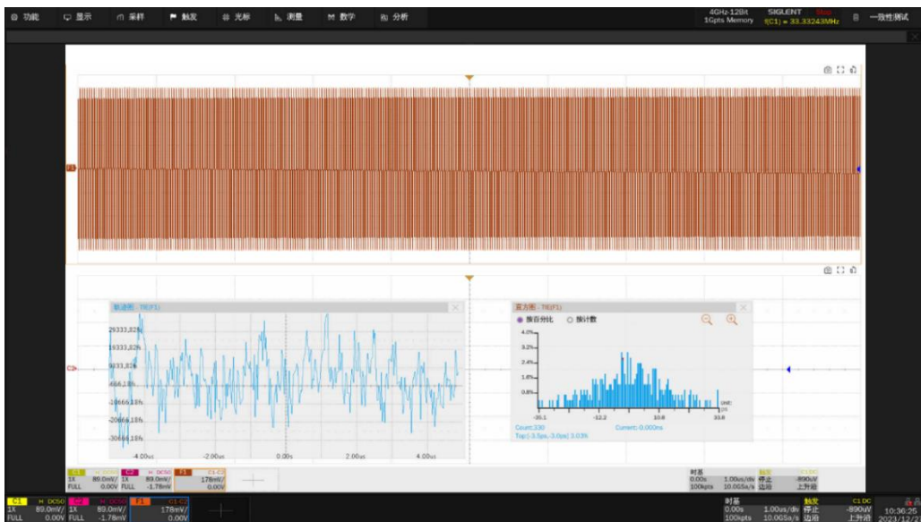
图 5-7 发射时钟频率和发射机时序抖动测试结果波形细节
