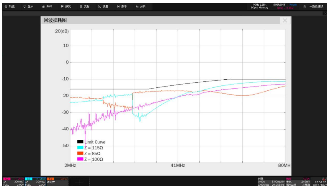
图 6-20 发射机回波损耗波形细节
