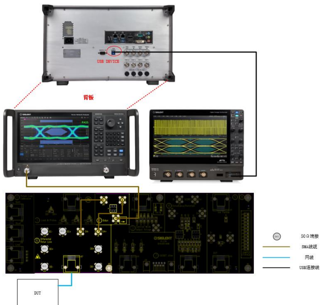
图 6-18 发射机回波损耗测试环境
