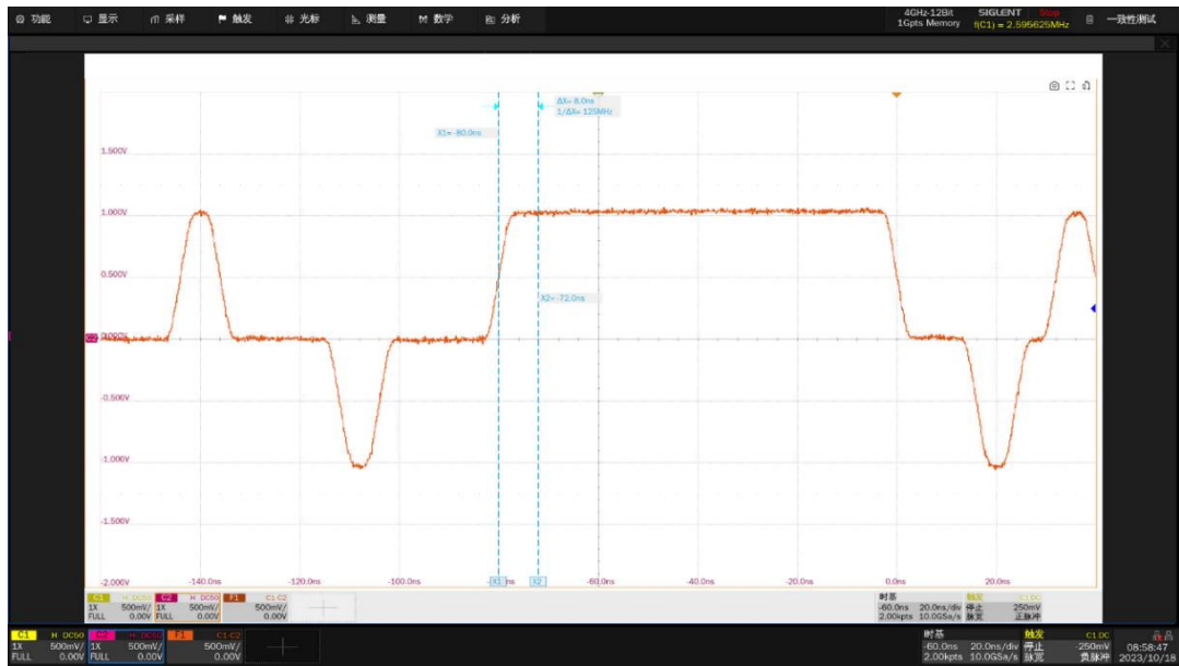
图 6-9 过冲测试波形展开细节
