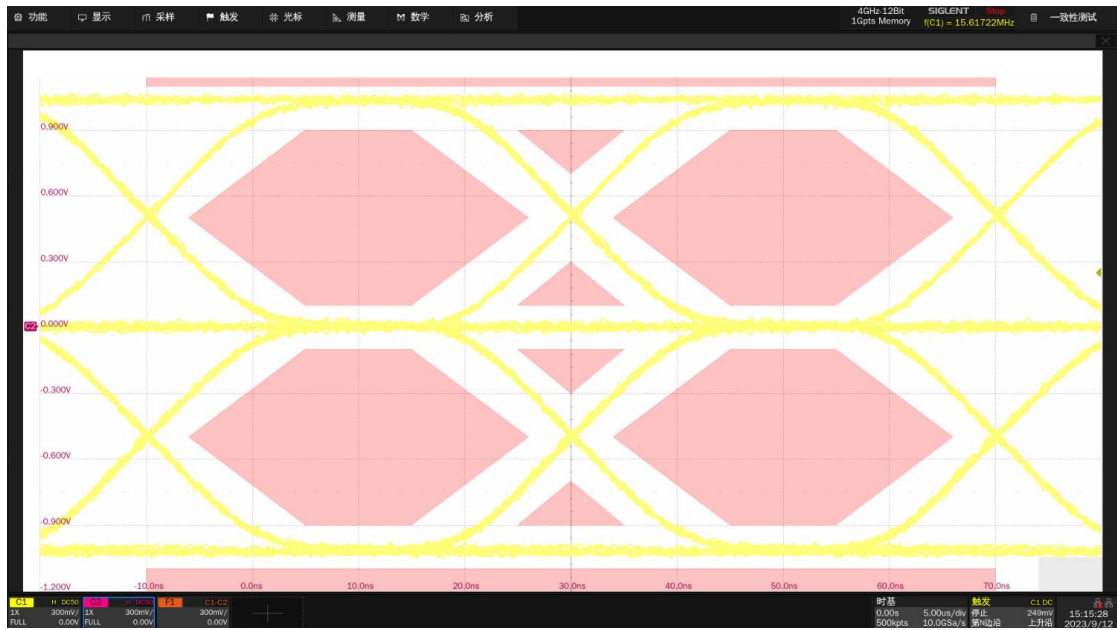
图 6-3 模板测试的波形展开细节
