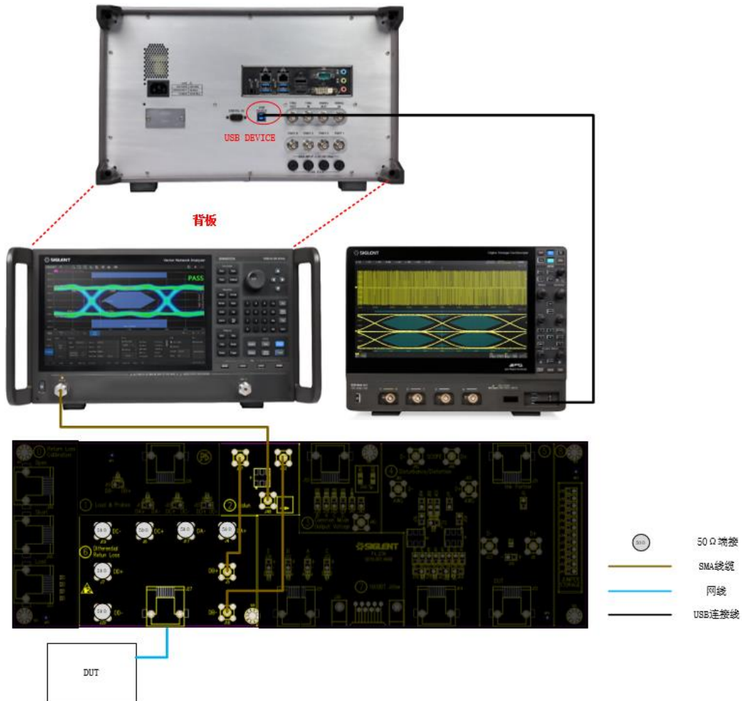
图 6-22 接收机的回波损耗测试环境
