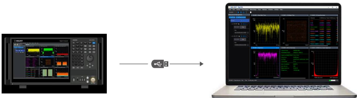
测量仪器设备中导出指定的波形文件，通过 U 盘或网络服务器放到电脑硬盘，然后使用 SigVSA 导入功能导入波形数据，进行矢量分析。
