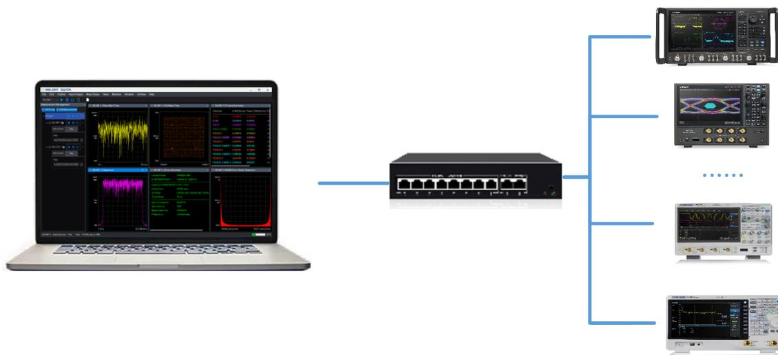
这种场景下，SigVSA 矢量信号分析软件执行云控制功能，可进行网内自动搜索仪器，根据需要选择仪器，进行远端控制和采集。SigVSA 采集数据后，在线读取远端的波形数据，然后执行本地数据分析，可不依赖于仪器矢量分析选件。
