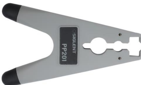
两脚定位器 PP201：用于探头固定。
