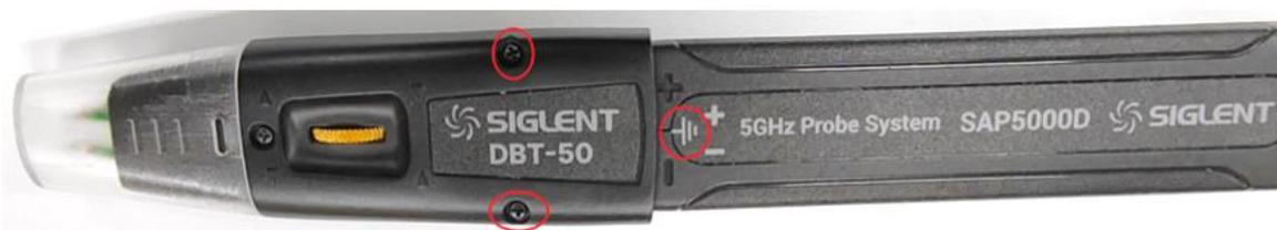
DBT-50 与探头放大器请按上图连接，注意红圈的螺丝和接地标识。安装完成后如下图。
