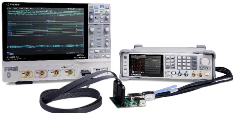
购买相应的数字总线套件，可实现 16 路 LVTTL 或 LVDS 输出，比特率在  $1 \mu\text{bps} \sim 1 \text{ Gbps}$  范围内任意可设置，搭配模拟通道实现混合信号输出
