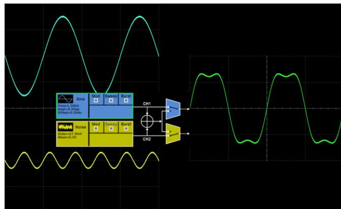
**双通道合并** 能够将两通道波形合并后输出,具备实时性好、可叠加真正的噪声、可叠加调制信号、扫频信号、Burst 信号、EasyPulse 波形和 TrueArb 波形的优点,为用户提供了精确生成复杂波形的新手段
