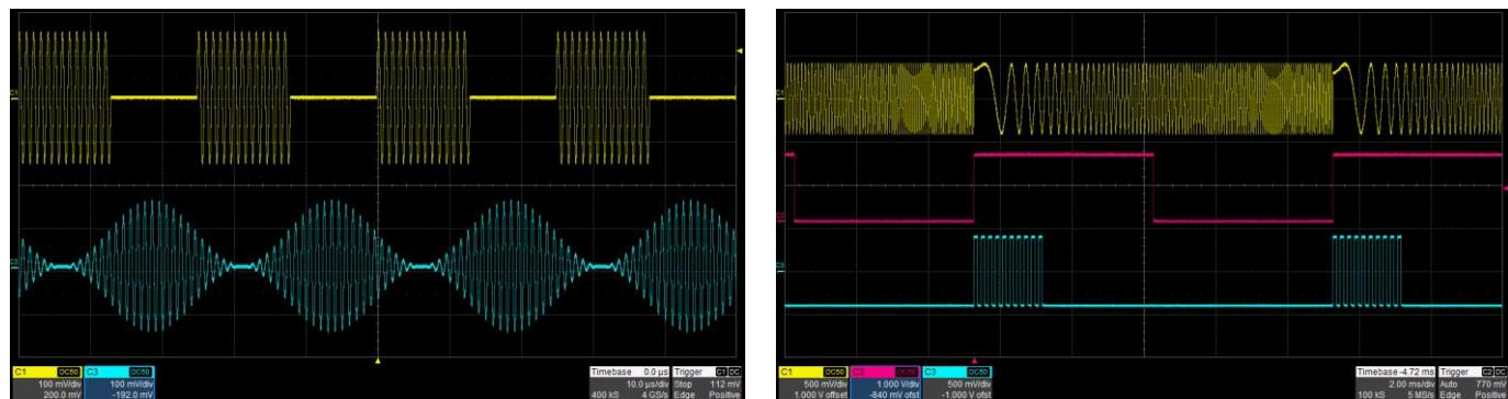
**调制** 支持 AM, FM, PM, FSK, ASK, PSK, DSB-AM 和 PWM 等多种模拟和数字调制方式，有“内部”、“外部”和“通道”三种调制信号源
