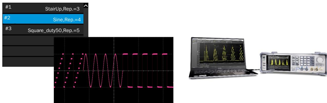
**分段编辑和播放** 提供把最高 1024 段任意波无缝拼接的能力, 每段波形可单独设置重复次数, 最高次数 65535 次。这种模式在切换任意波时直接从前一段的最后一个点跳转到后一段的第一个点, 不会产生空闲电平, 适用于对波形切换要求很高的场合
