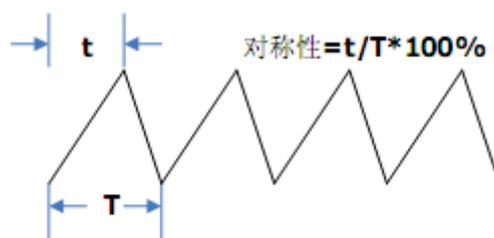
选择 **Waveforms** → **Ramp** → **对称性**, 可设置对称性百分比数值。屏幕中显示的对称性
