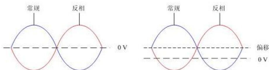
**备注：**在波形反相时，与波形相关的同步信号并不反相。
